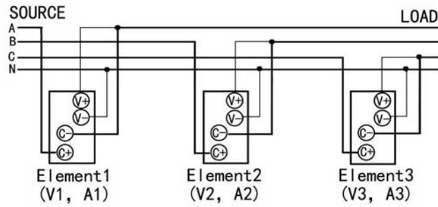
C: 3 电压 3 电流 (3V3A)
